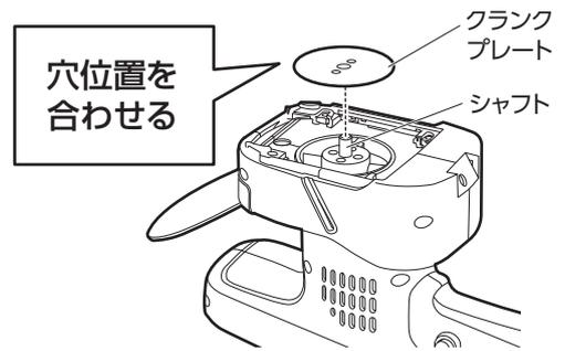
6. 交換用ブレードのシャフト穴に、本体のシャフトを通して取り付けてください。
