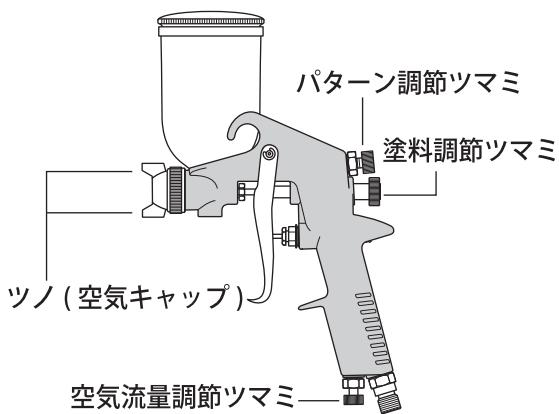
① 塗料調節ツマミを回して塗料量を調節します。
