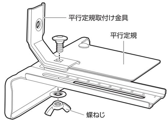
2. 本体に取り付けてある平行定規固定ねじで平行定規を本体に取り付け、固定ねじをしっかりと締め付けてください。
