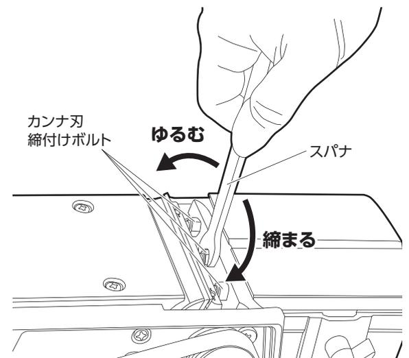
4. ベルトを手で回してカンナ胴を回転させ、反対側も同様に確認してください。確認後はベルトカバーを元のようによく取り付けてください。
