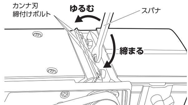
2. カンナ刃をスパナで押し出し、新しい刃を取り外しと逆の要領でホルダーに差し込んでください。その後、カンナ刃締付けボルト3本をしっかりと締め付けてください。
