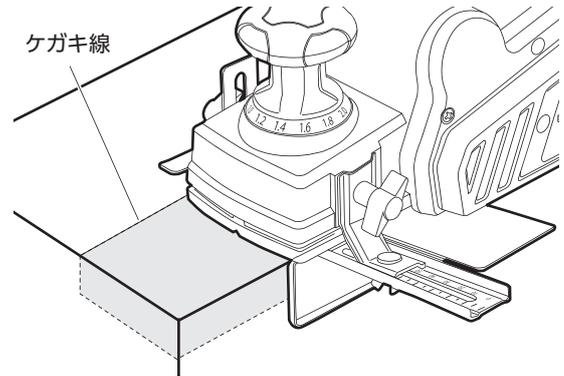
3. フロントベースの右端をケガキ線に合わせて本体を置き、平行定規を加工物の側面にぴったり合わせて蝶ねじを締め付け、固定してください。
