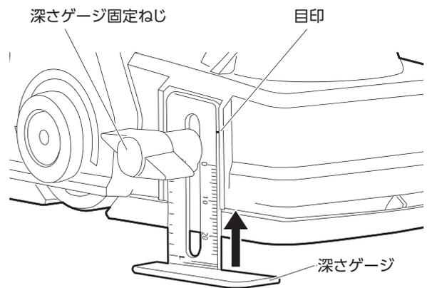
5. 平面削りと同じ要領で作業してください。深さゲージが加工物に当たるまで切削してください。
