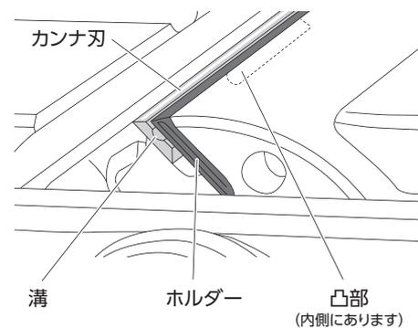
3. ベルトを手で回し、反対側も同様にカンナ刃を交換してください。
