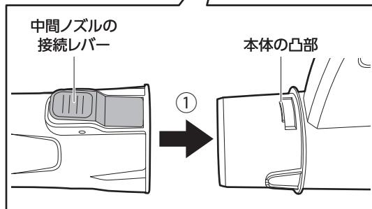
2. 中間ノズルの凸部と先端ノズルの接続レバーを合わせ、「カチッ」と音がするまで差し込んでください。(②)
