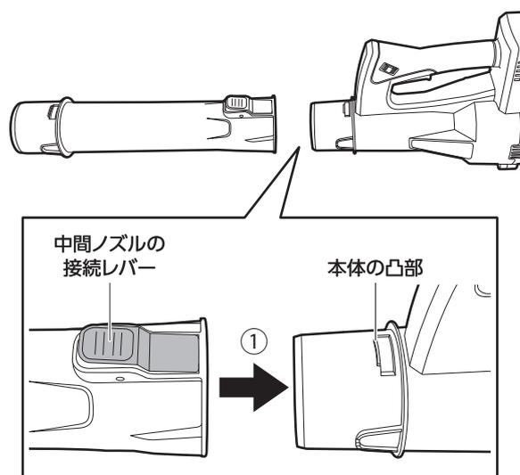
2. 中間ノズルの凸部と先端ノズルの接続レバーを合わせ、「カチッ」と音がするまで差し込んでください。(②)
