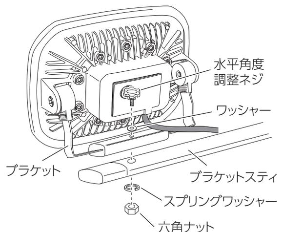
3. スタンドポールの突起が正面になるように置き、ブラケットステイ・ジョイントケース金具・ワッシャー・スプリングワッシャー・水平角度調整ネジの順に取り付け固定してください。
