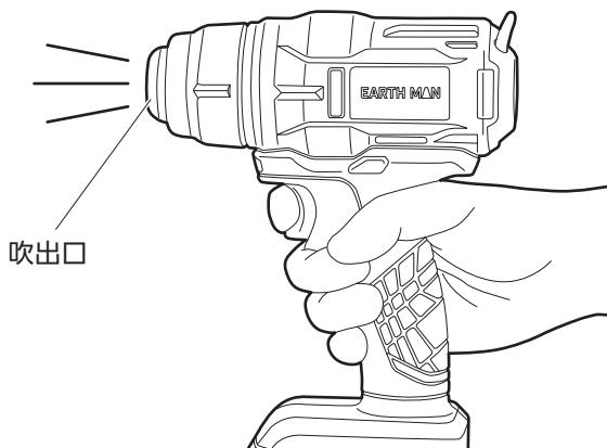
POINT! 加工物によって熱風を当てる距離が異なります。目安として紙・木材・プラスチック等の可燃物には10cm以上、金属・石材等の非可燃物には5cm以上の距離をあけて使用してください。作業前に廃材などでテストすることをお勧めします。
