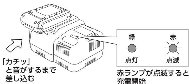
3. 約60分で充電が完了すると、赤ランプが点灯します。充電が完了したら、リリースボタンを押してスライドさせてバッテリーパックを充電器から取り外してください。
