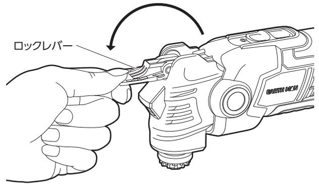
2. 固定ナットを「ゆるむ」方向へ回し、取り外してください。
