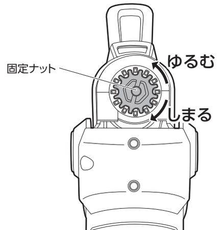
3. 取付け軸の突起に先端パーツの穴を合わせて差し込み、固定ナットを回して取り付けてください。
