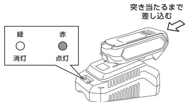
3. 約70分で充電が完了すると、点灯しているランプが赤→緑に切り替わります。充電が完了したら、バッテリーパックを充電器から取り外してください。
