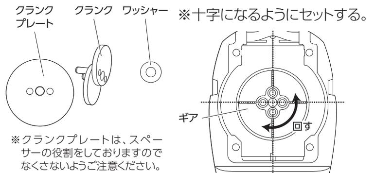
2. ギアの上にクランクプレートとクランク・ワッシャーを順番にセットします。
