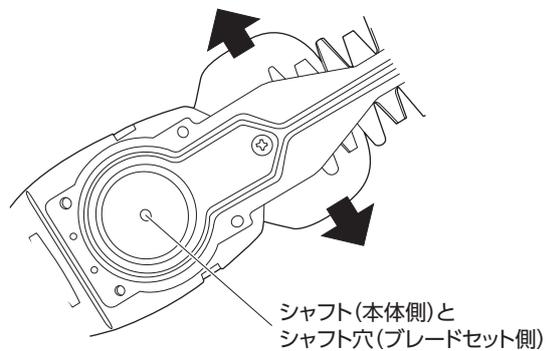
6. 底カバーを、取り外し手順(※P18参考)とは逆手順で取り付けます。
