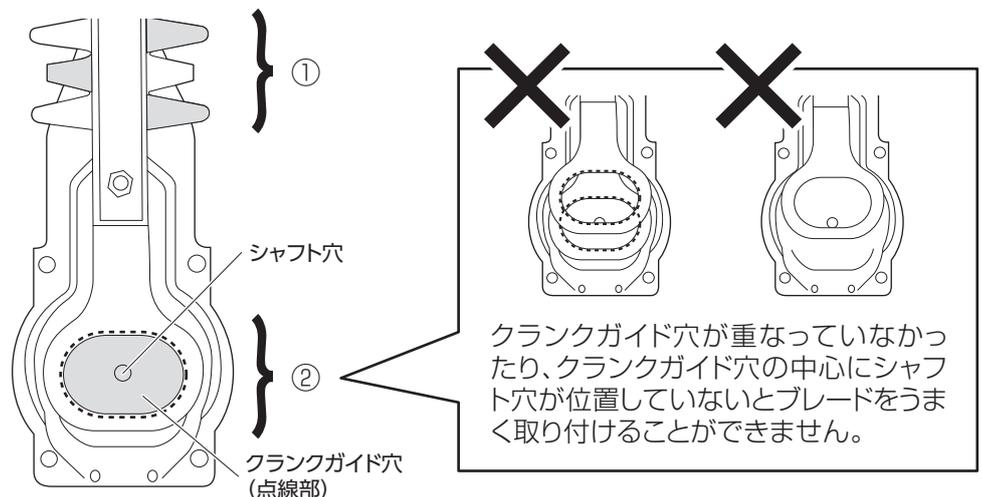
5. シャフトとシャフト穴、クランクとクランクガイド穴が合うようにブレードをセットします。
