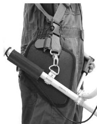
③ お手持ちの刈払機に「脱着金具」を取り付け、パッドの「ハード面」に刈払機のパイプがあたっていることを確認のうえ、作業を始めてください。
