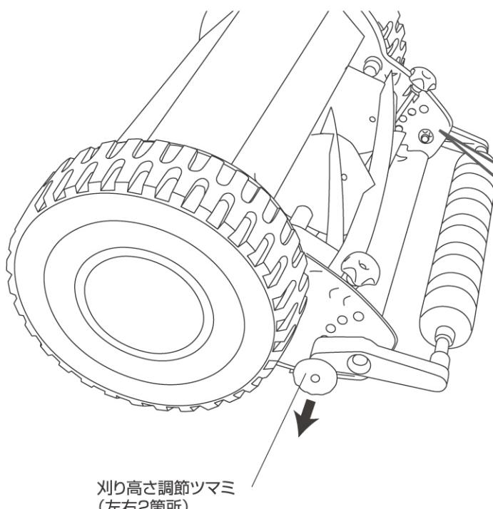
左右にある刈り高さ調節ツマミを引きながら上下に動かし、作業に応じた刈り込み高さに調節してください。左右とも同じ高さになるように刈り高さ調節ツマミをしっかりと固定します。
