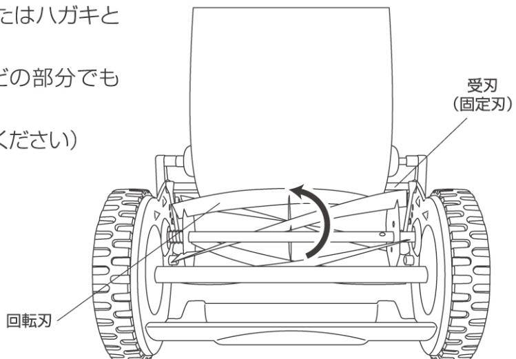
擦り合わせが強すぎると、刃の寿命を短くするばかりでなく、故障の原因となります。また、擦り合わせが弱すぎると、刈り込みが困難となるばかりでなく、芝生を痛める原因になりますので調整は確実に行ってください。
