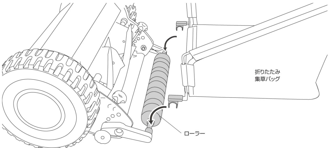
2.バンドを取り付け、折りたたみ集草バッグの高さを調節します。
