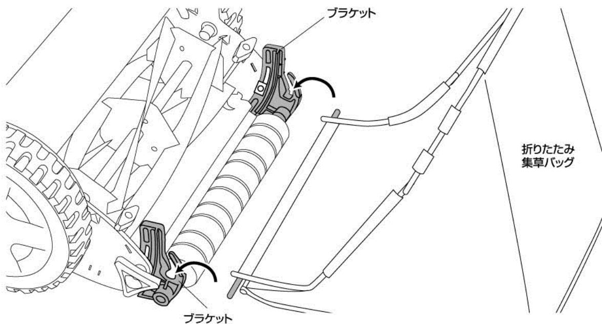
2. バンドを取り付け、折りたたみ集草バッグの高さを調節します。
