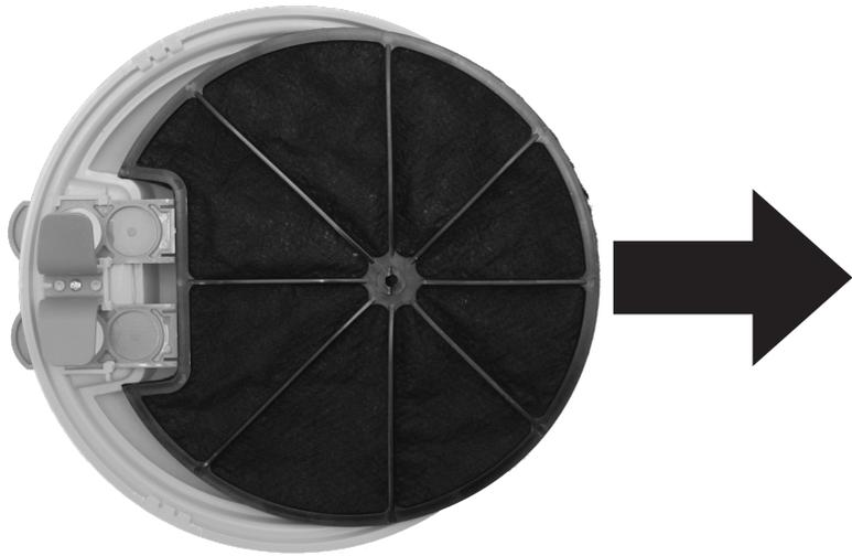
3. 交換用フィルターを取付け、ねじを元のようにきちんと締めてください。
