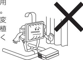
使用中、本体が非常に高温となりますので、火災・ヤケドには十分注意し、お子様は近くに近づけないでください。また、布などで覆ったり可燃物を近くに置かないでください。電源コードが本体フレームにかからないようにしてください。本体にコードがかかるとコード被覆が溶け故障・火災の原因になります。
