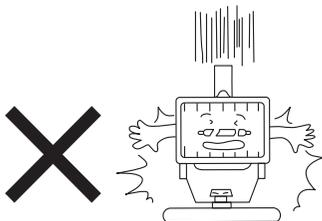
ハロゲン投光器の前面に物を置くと火災の原因になりますので1.5m以上離してください。前面以外の周囲もそれぞれ50cm以上離してご使用ください。また、暖房器具の代用としないでください。高温・高熱となり大変危険です。ペットや植物へは照射しないでください。
