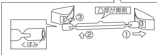
4. ハロゲンランプが落下しないことを確認してからフレームカバーを閉じ、フレーム前面ネジをしっかりと締めてください。
