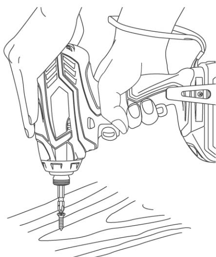
2.ビットをネジ頭部の溝にきちんとあて、スイッチ引金を引きながら、ビットがネジ頭部の溝から外れない程度の力で押し付けてください。
