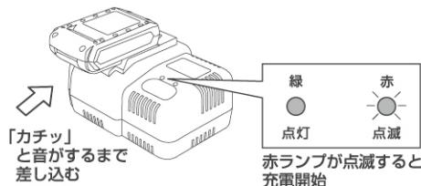
3. 約40分で充電が完了すると、赤ランプが点灯します。充電が完了したら、リリースボタンを押してスライドさせてバッテリーパックを充電器から取り外してください。
