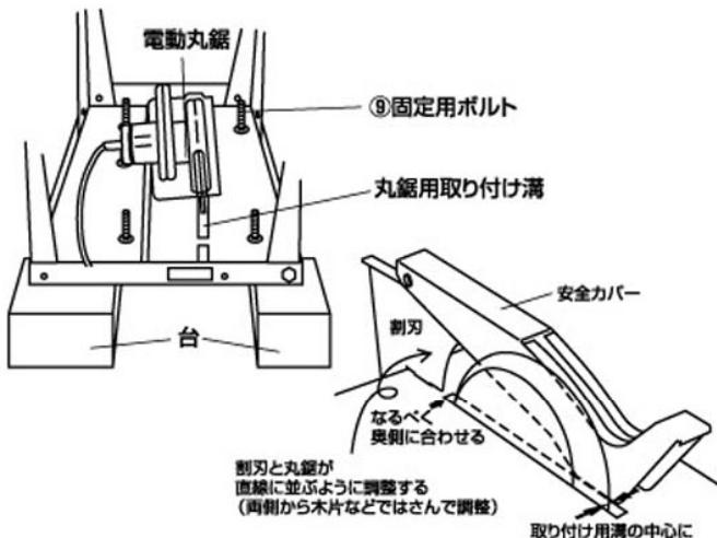
◆電動丸鋸を取り付けた際に鋸刃、もしくは③丸鋸用安全カバーが地面に触れない程度の高さがある台を2つ用意し、その上に組立てた丸のこ専用スタンドを裏返しに置いて、電動丸鋸を固定位置にセットします。
