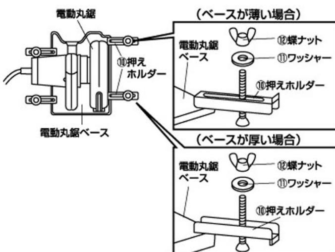
◆鋸刃の位置が決定したら、⑨固定用ボルトに、⑩押えホルダー・⑪ワッシャー・⑫蝶ナットの順でセットし、電動丸鋸のベースをしっかりと固定して下さい。 (4箇所)
