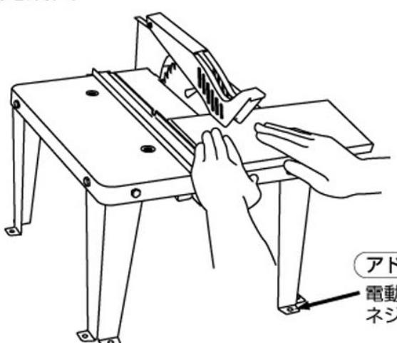
切断を行う際にはしっかりと電動丸鋸の鋸刃の回転を上げ、回転数が一定になってから、ゆっくりと一定の速度で材料を押し込んで切断して下さい。
